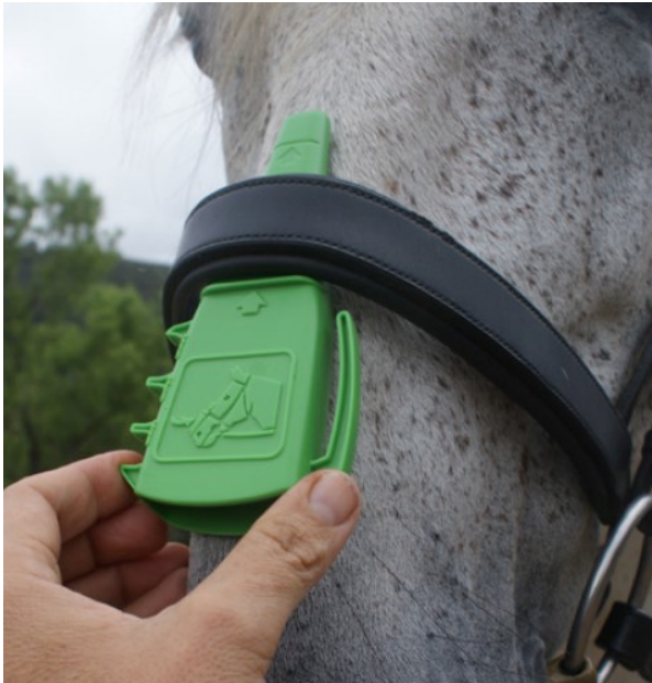
Kuva: Turparemmin kireyden tarkistamiseen esim kilpailuissa on kehitetty tällainen mittari..
