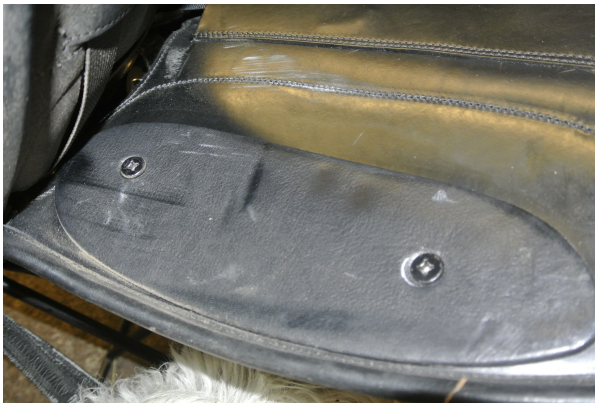
Kuva: polvituki liikkuu monipuolisesti, mutta kiinnitykseen olisin laittanut ainakin kuusiokoloruuvien, joka olisi helpompi kiristää tukevasti kuusiokoloavaimella.
